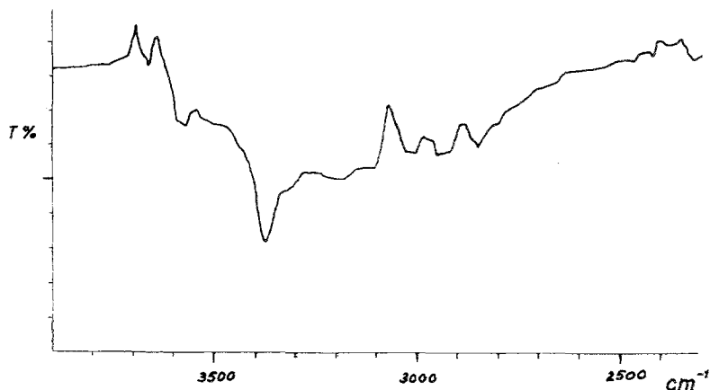
Abb. 1. IR-Spektrum des N,N'-Diphenylhydroxythioharnstoffes in gesätt. Chloroformlösung
